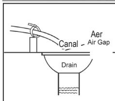
**Fig. 5 Conectare la canalizare**
