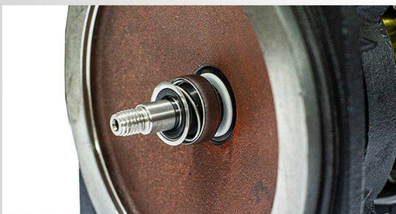
Garnitura mecanică: ceramică/grafit/NBR
