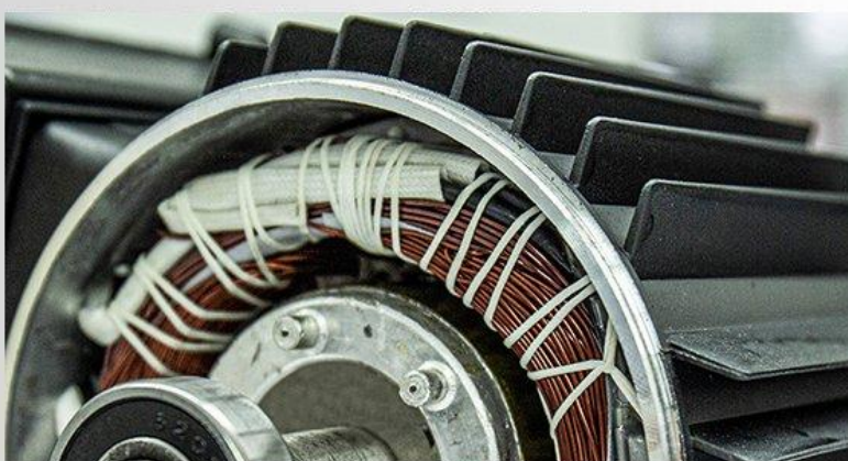
Carcasa motorului din aliaj de aluminiu
