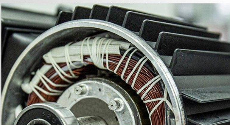
Carcasa motorului din aliaj de aluminiu
