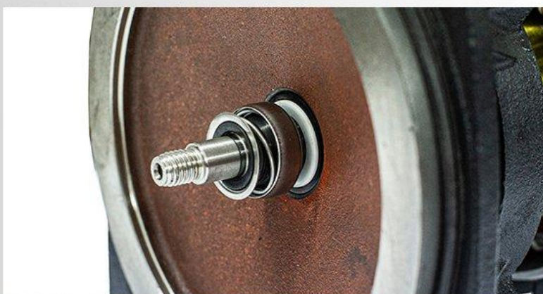
Garnitura mecanică: ceramică/grafit/NBR
