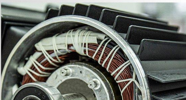
Carcasa motorului din aliaj de aluminiu
